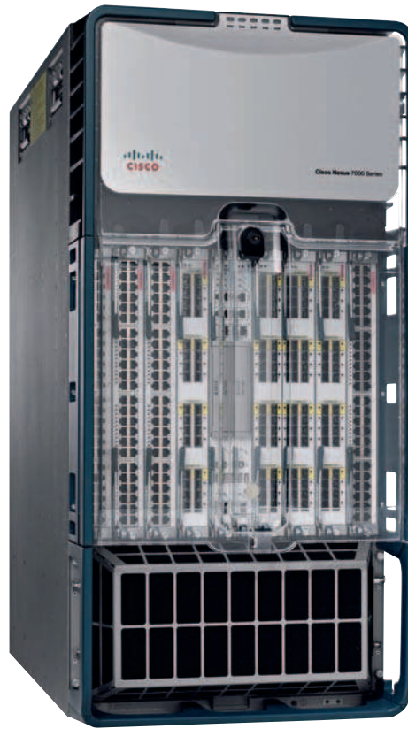
Der Nexus 7000 - Ciscos erster Switch für das Data Center 3.0.
