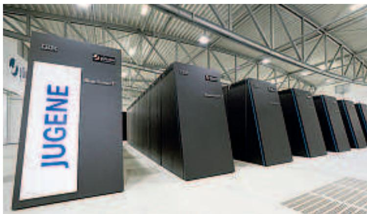
„Blue Gene/P“. Im Inneren arbeiten knapp 300.000 Power-PC-Prozessoren mit einer Taktfrequenz von jeweils 850 Megahertz. Der Arbeitsspeicher umfasst 144 Terabyte. Die Installation ist auf 72 wasserge-
